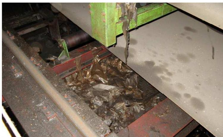
Figura 9: presenza di carta sul tetto della saldatrice.
