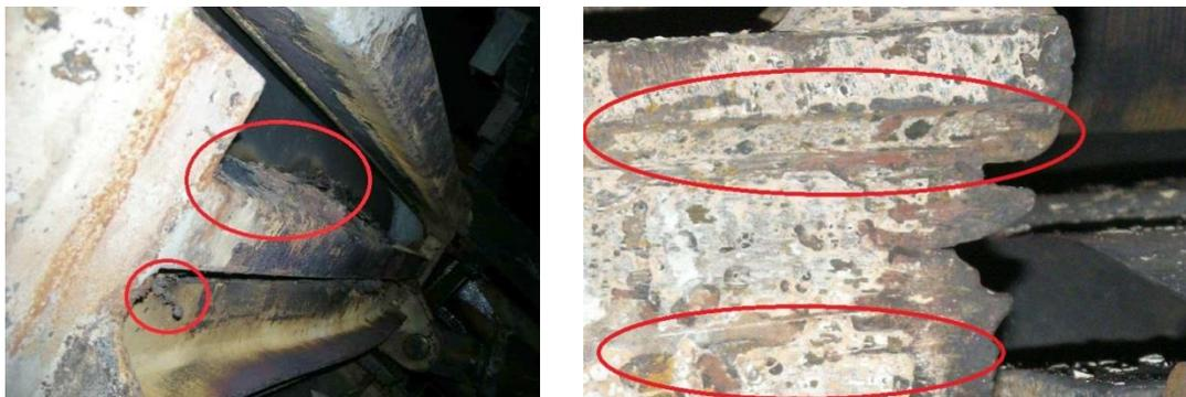
Figure 11 e 12: segni di sfregamento del nastro contro la carpenteria metallica.
