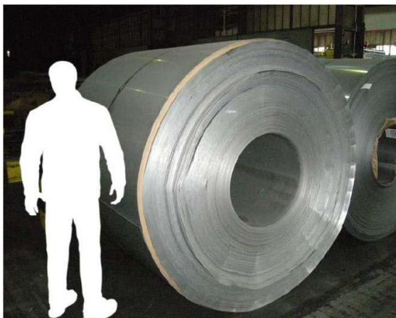
Figura 1: *Coil* di acciaio, il cui diametro può raggiungere i due metri<sup>6</sup>.
